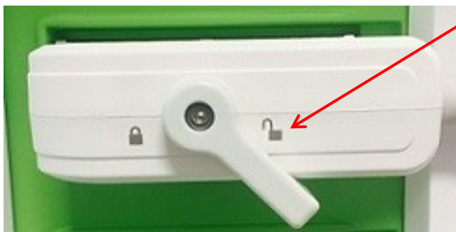
Slika 11: Odklenjen zaklepni gumb konektorja sonde
