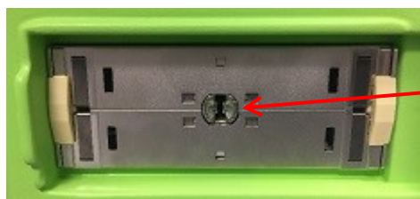
Slika 9: Zaklepna zareza na priključku za konektor sonde
